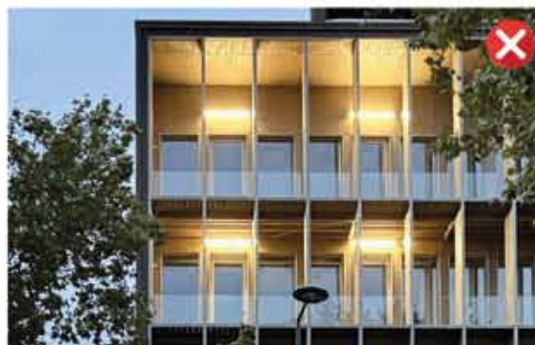
Luminaire de type tube lumineux éclairant le ciel et source d'éblouissement
